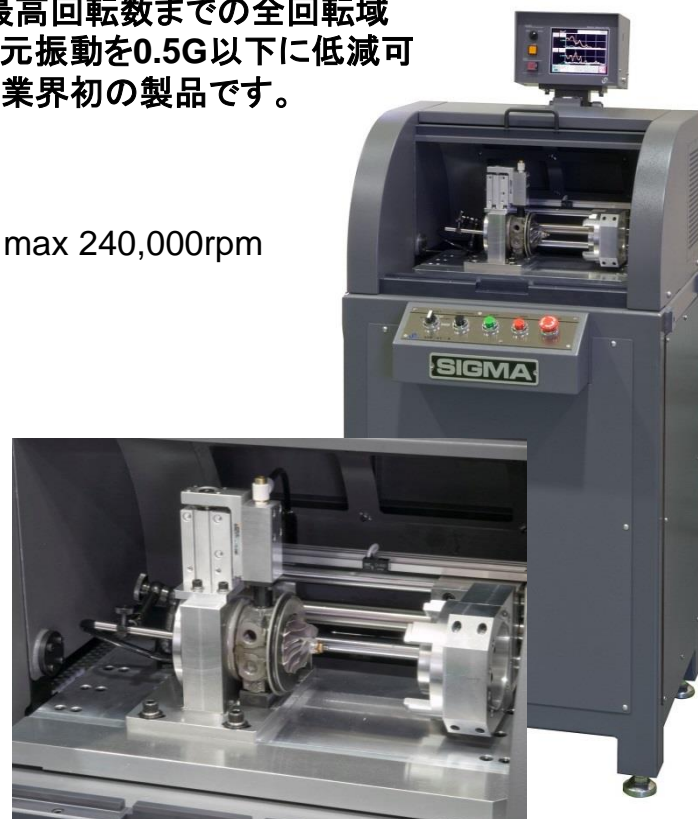
写真-3 ターボASSY専用釣合い試験機
