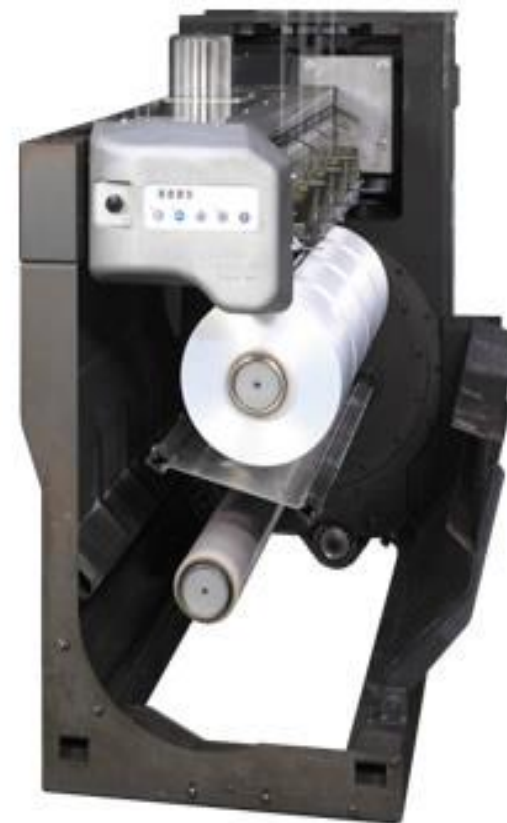
写真-1 繊維巻取り装置(ワインダ) (Max 30,000rpm)
